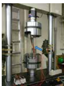
テンションロッドの疲労試験
