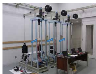
テンションロッドのクリープ試験
