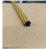
7本組紐より線の中央のFRP素線に切り欠きを入れ, そこに光ファイバセンサを埋め込んだ光ファイバセンサCFRTPアンカーロードを作製する方法を確立する。
