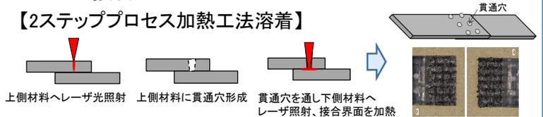
上側材料に貫通穴を形成し、貫通穴を通して下側材料へ直接レーザーを照射接合界面を加熱する工法(厚板接合法)
