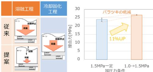
加振時の加圧力を抑制することで接合力のバラツキ抑制、接合力の増加が得られた
