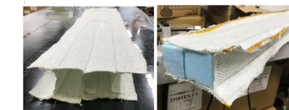
シームレスプリフォーム：設計製紐可能 コア材同時成形投入可能
