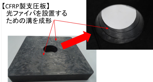
中空部に設置した光ファイバセンサで軸力挙動やアンカー破断を計測・モニタリング
