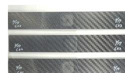
図4. 重ね合わせ接合した試験片
