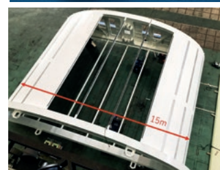
大型貨物船に搭載する硬翼帆
