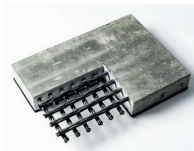
FRP筋コンクリート
