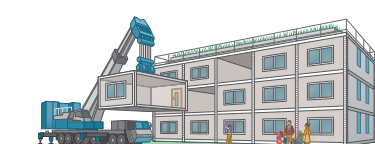
スケルトン(構造躯体)と インフィル(住宅内装)のユニット構造
