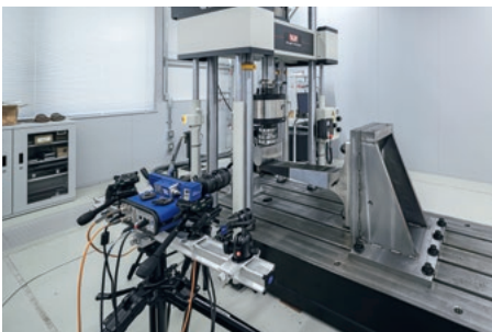
CFRPと金属接合部の大型疲労試験 (表紙写真)
