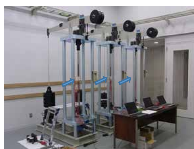
テンションロッドのクリープ試験
