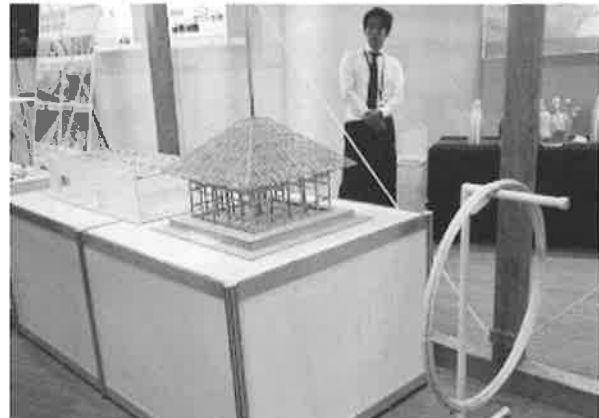
写真10 CFRPロッド(写真右)を使って既存建物の耐震補強を行った善光寺経堂の構造模型
