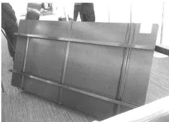
写真13 連続プレス成形パネルとロールフォーミングによる長尺プロファイル材を適用した軽量高剛性パネル
