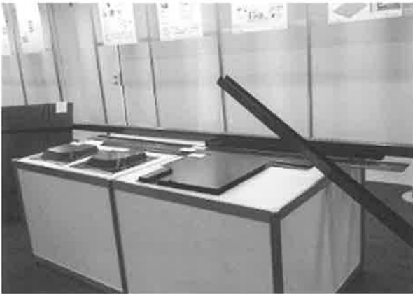
写真24 熱可塑性エポキシ樹脂/薄層CFをダブルベルトプレス成形した立体形状製品（テーブル左）と連続（間欠）プレス成形による長尺材
