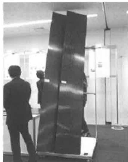
写真15 ダブルベルトプレスによる連続成形長尺厚板(右)、CF繊維/PAG)と熱可塑性エポキシ樹脂/薄層CFテープを等方的に積層したランダムシート(左)
